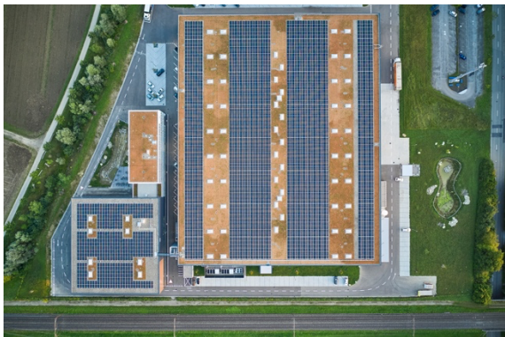
Die Solaranlagen auf den Dächern des Forster Campus erzeugen bis zu 15 MWp Strom pro Jahr und versorgen die Produktion und den Gebäudebetrieb mit nachhaltiger Energie. Foto: © leader.ch
