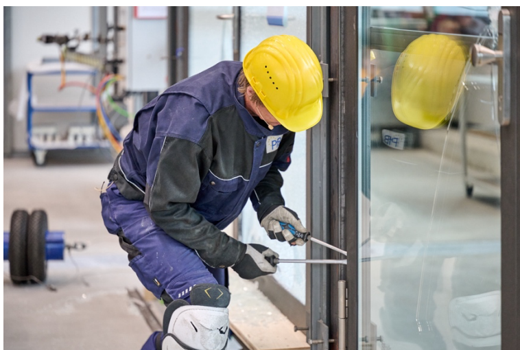
Démonstration en direct des normes de sécurité : Plusieurs tests d'effraction répartis sur la journée ont montré la stabilité et la résistance des systèmes de profilés Forster en acier robuste. Photo : © Thomas Hary
