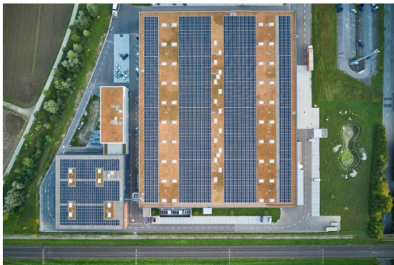
Die Solaranlagen auf den Dächern des Forster Campus erzeugen bis zu 15 MWp Strom pro Jahr und versorgen die Produktion und den Gebäudebetrieb mit nachhaltiger Energie. Foto: © Thomas Hary
