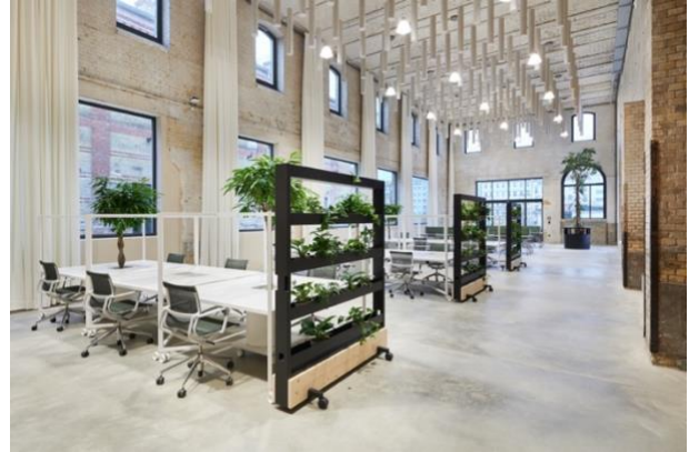
Für eine angemessene Akustik im großen Raum sorgen Theatervorhänge in Kombination mit der speziell entwickelten Deckeninstallation aus Wollfilzabsorbieren. Foto: Yves Sucksdorff
