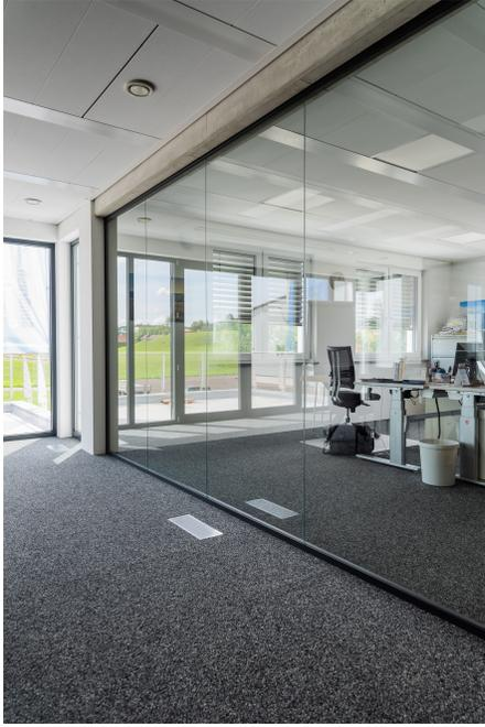
Le système de cloisons SANCO DIVIDE EASY n'a pas de bords de fermeture intermédiaires, ce qui minimise le risque d'accident. Photo : TA Werbeagentur
